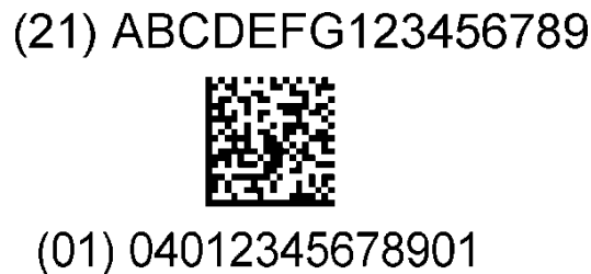
Figura 2.6.14-4. Ejemplo de símbolo DataMatrix GS1 codificado con GTIN y número de serie AI (21)
