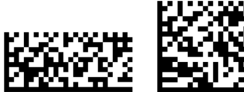
Figura 5.6.3.1-1. Símbolos GS1 DataMatrix rectangulares y cuadrados (no se utilizan aplicaciones específicas en la codificación de los datos. Ambos símbolos contienen los mismos datos).
