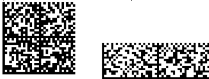
Figura 5.6.3.2-3. Símbolos GS1 DataMatrix segmentados: Los formatos cuadrado y rectangular (los tamaños de estos símbolos GS1 DataMatrix son mayores de lo que se utilizaría en una aplicación típica para que puedan observarse con facilidad los patrones de alineación típicos).
