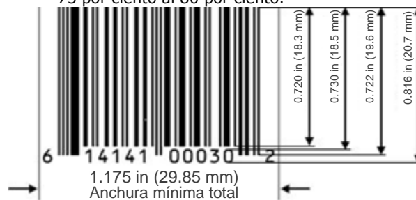
Figura 5.12.6.3-1. El símbolo EAN/UPC se muestra con las dimensiones de altura mínima y anchura total para aumentos del 75 por ciento al 80 por ciento.
