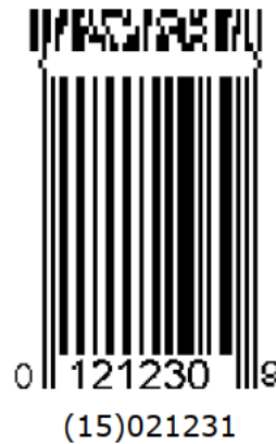
Figura 7.8.6.3-2. Ejemplo de simbologías GS1 mixtas (GTIN codificado en UPC-E, fecha de consumo preferente en Composite)
